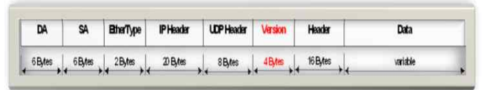
그림 4. Ethernet Frame Format
