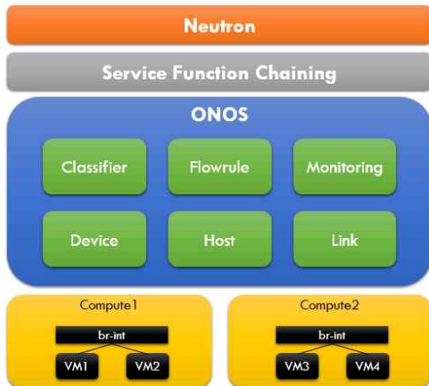
그림 1. SDN기반 서비스 체이닝 구조
